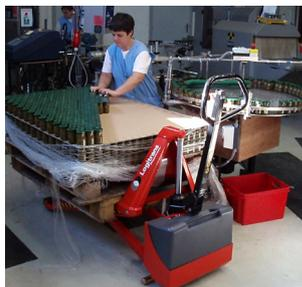
L'arrêt d'urgence de la version électrique est placé sur le timon. Les fourches s'arrêtent rapidement et précisément.
